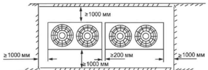
Вид агрегатов сверху (схема монтажа нескольких агрегатов)
